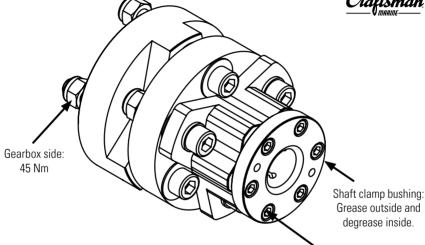
Type-2: M6x20: 18 Nm Type-4: M8x20: 41 Nm
